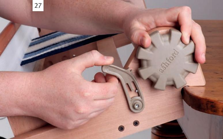
ハンドルを少し後ろに回し、ストッパーを引いて歯車から外してたて糸の張りを緩めます。ハンドルを手前に回すとたて糸が巻き戻ります。ストッパーを留めます。
