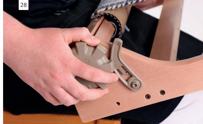
次に、前ハンドルを手前に巻き、最終段が前ローラーから約5cm離れた辺りにくるまで巻き取ります。たて糸の張りを調整します。織った布はこのように前ローラーに巻いていきます。
