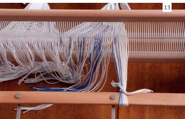
全てのたて糸を穴と溝に通したら、数本の束ごと後ワープステイックに結びます。「初めてのスカーフを織る」のステップ19-21を参照してください。
