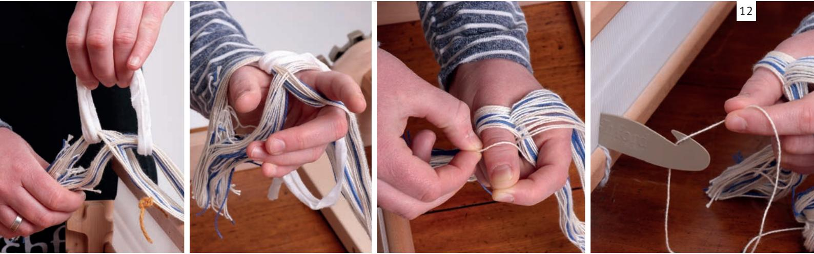
おさを休み位置に置きます。綾の部分のすき間にそれぞれ親指と人差し指を通します。綾のクロスになっている部分の一番外側の糸を取ります。織機の後ろ側からおさの溝にフックを差し込み、織機の前側で糸を掛けて引き抜きます。続いて、おさの穴にフックを差し込み、糸を引き抜きます。
