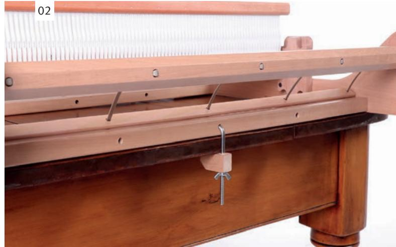
織機の後ろレールの真中の穴にクランプを差し込み、織機をテーブルに固定します。
