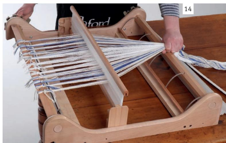
前ローラーに結んでおいたたて糸を解きます。たて糸を引っ張り気味にし後ろローラーに巻き付けていきます。誰かに手伝ってもらえる場合は、織機の前側で、鎖編みの端を持ってもらい、糸の張りを保ちながら巻きとります。
